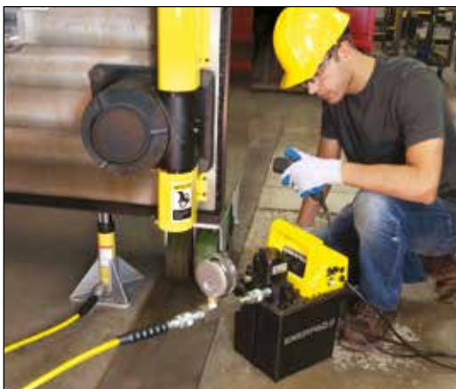
◀ La pompe immergée (série PEJ) avec télécommande à impulsions simplifie l'entretien de cette machine.
