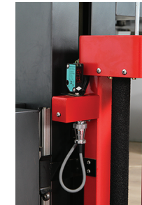
- Photocellule pour la détection de la hauteur de la palette.
