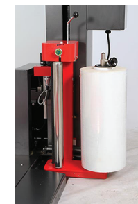
- Tension de film mécanique et réglage de tension par un moteur réducteur.
